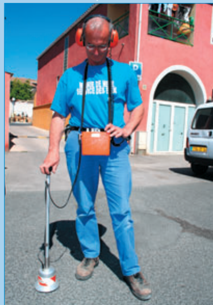
Didier Van Elst, responsable du service des eaux de la ville, traque la moindre fuite sur le réseau à l'aide de capteurs sonores ultra-sensibles.
