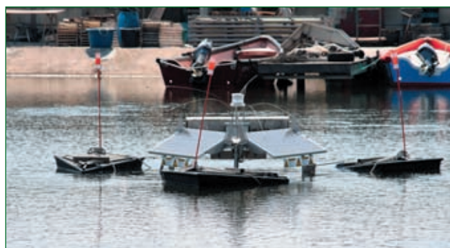
L'énergie solaire pour oxygéner l'eau du port du Mourre Blanc.
