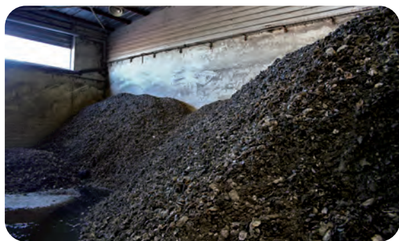
Séchage des déchets conchylicoles dans des blocs ventilés.
